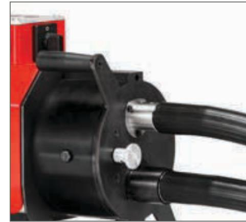
Conexión para dos ejes: DIN 10 y DIN 15
