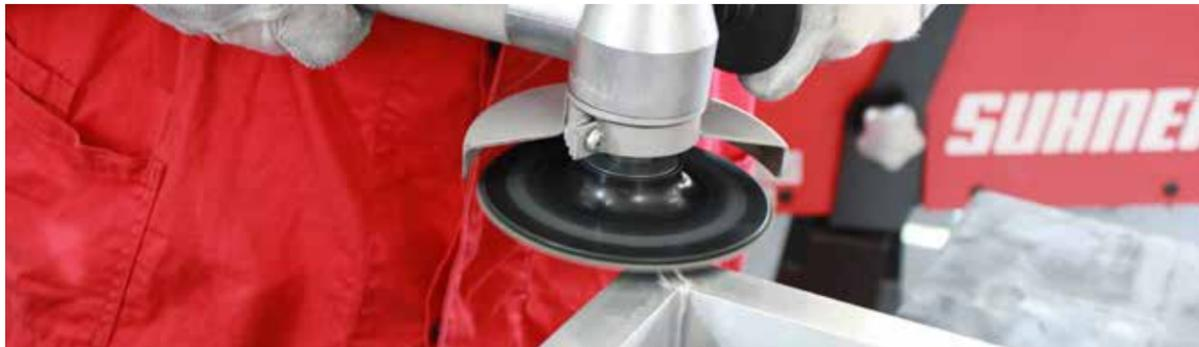
Disques sur fibre oxyde d'aluminium
