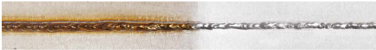
Soldadura WIG con dos pasadas
